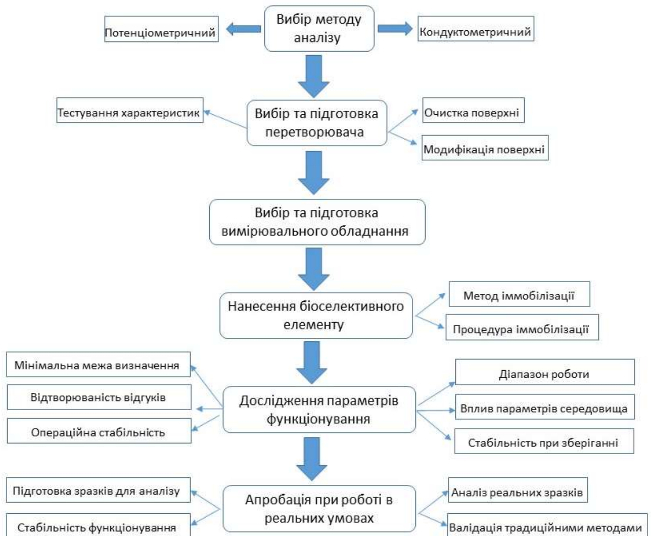
Рисунок 6.2 – Схематичне представлення процедури створення електрохімічних біосенсорів на основі холінестераз
